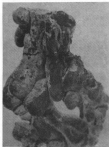
Εικ. 2. Σκουρίό από έκκαμίνευση σίδηρου με τόν χαρακτηριστικό σχήμα δακτύλων, από τήν 'Αρχαία 'Αγορά της 'Αθήνας.
